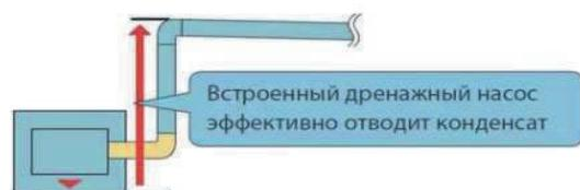
Дренажная помпа для отвода конденсата на высоту до 750 мм
